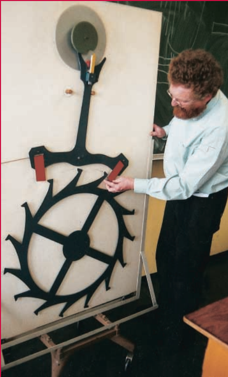
Karel M. Kolar erläutern an einem Gangmodell von Karl Geitz die Freie Ankerhemmung.
